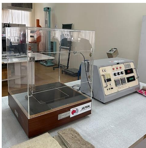
Рисунок 2.8 – Прибор AW-2 для измерения теплоудержания
