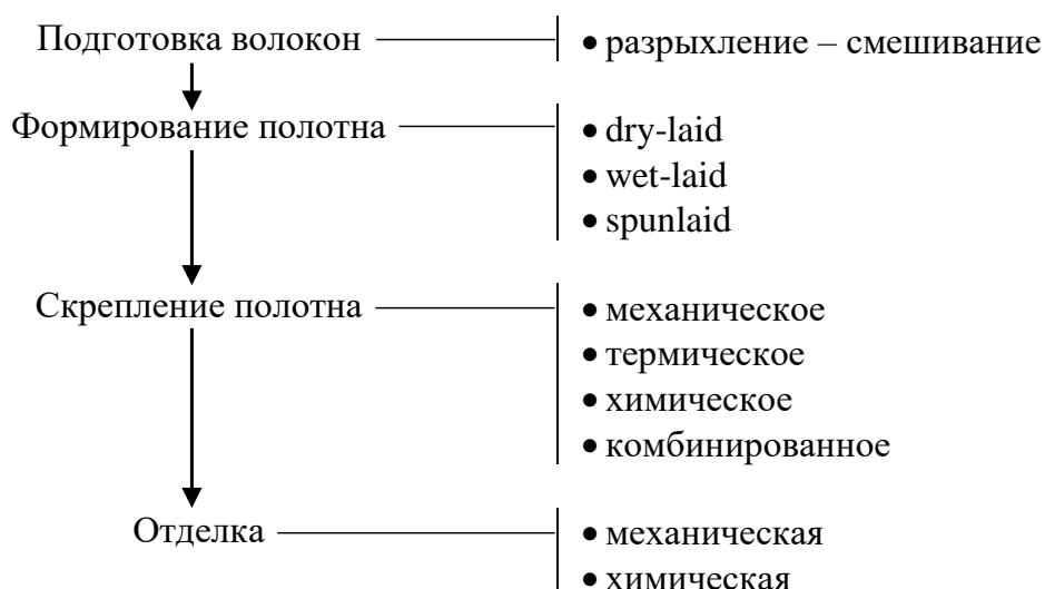
Рисунок 1.7 – Схема технологического процесса изготовления нетканых материалов [84, с. 253]
